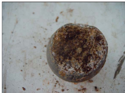
Foto 5: Sondeig S-1, boca SPT a 12 metres.
