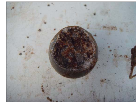
Foto 9: Sondeig S-2, boca SPT a 8,8 metres.
