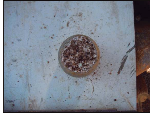
Foto 14: Sondeig S-3, boca SPT a 10,5 metres.
